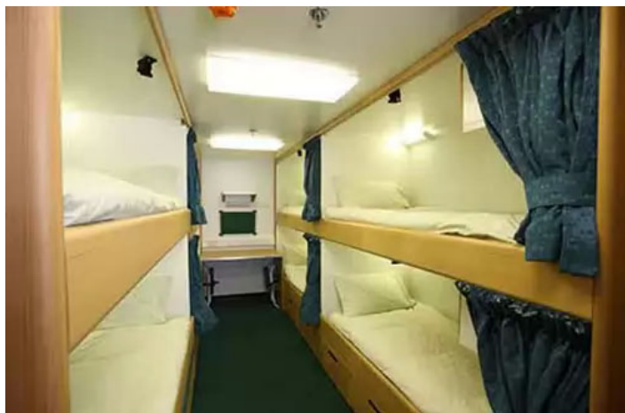
Рис.1 - Размещение энергосберегающих светильников в спальном помещении современного корабля.
